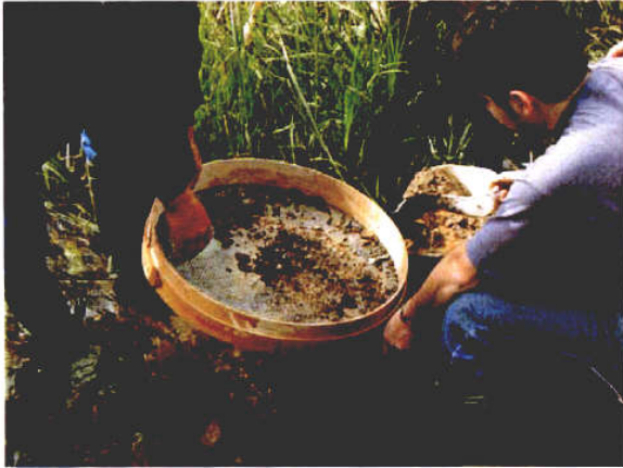
Foto 6-7. Detalle del tamizado de un sedimento
