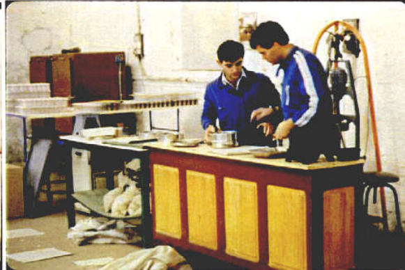
Foto 6-14. Tamizado de muestras en el taller de preparación
